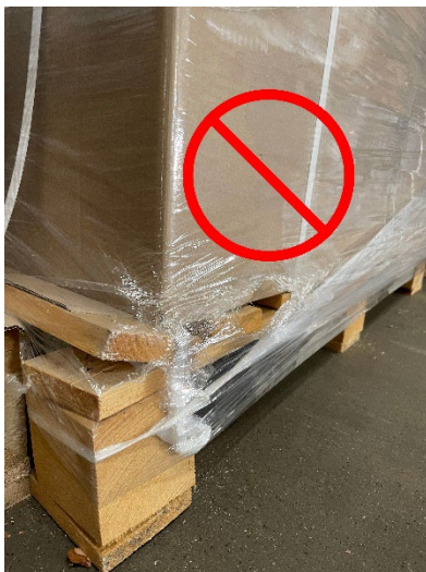
Abbildung links: gebrochene Einwegpalette bei Anlieferung Abbildung rechts: nicht ausreichend folierte und daher verrutschte Ware bei Anlieferung
