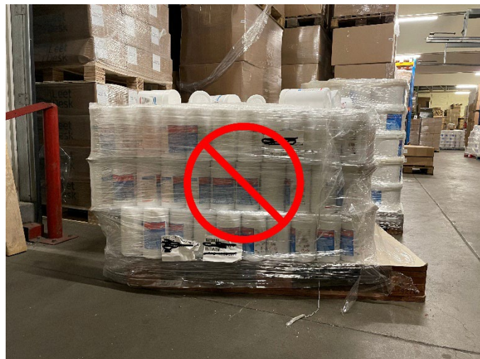
Abbildung links: gebrochene Einwegpalette bei Anlieferung Abbildung rechts: nicht ausreichend folierte und daher verrutschte Ware bei Anlieferung
